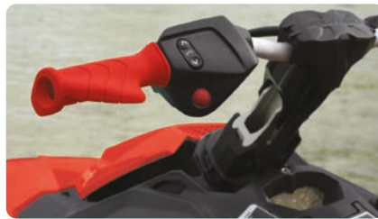
Capacité du VTS™ (correcteur d'assiette) étendue Offre le double de la capacité du VTS™ standard pour plus de facilité lors de l'exécution d'acrobaties.
